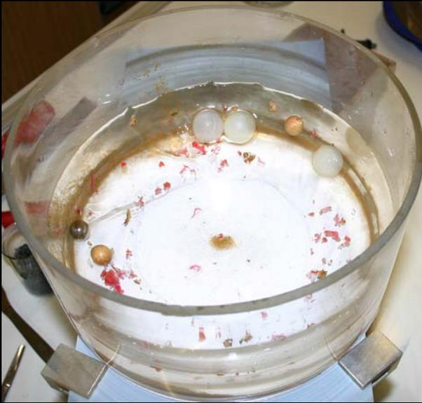
Eine mit Testteilchen (Sand, Körner, Kugeln) vermischte Flüssigkeit rotiert mit gleichmäßiger Winkelgeschwindigkeit: Alle Teilchen werden erwartungsgemäß nach außen gedrückt.
